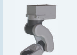
Roboter Teile ca. Ø 5 bis 35 mm werden ab Teilförderband, Zwischenhandlung oder Subspindel abgegriffen und in Paletten Std. abgelegt.
