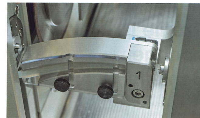
Die getrennten Teile werden über verschiedene, auf die Teilegröße optimierte, Absaugleitungen aus der Spanneinheit zum DepotMini abgesaugt (Bilder: MAW GmbH)
