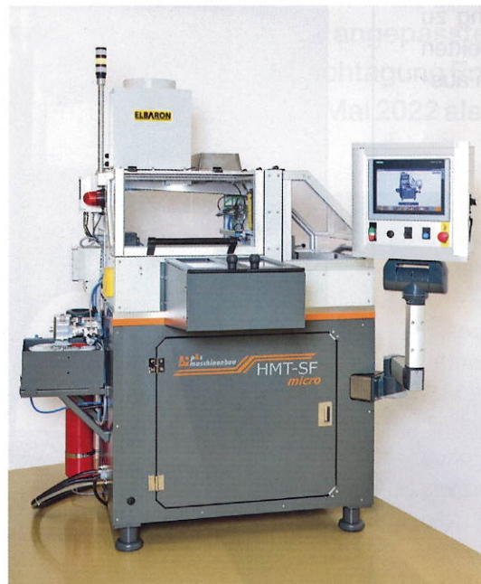
DepotMini mit zwei Vakuumköpfen M und XS sowie Behälter für Stangenendteile
