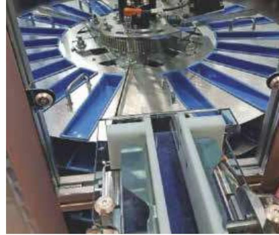
Teilespeicher für Drehteile Depot-Max 40 x 200 mm. Bild: MAW
