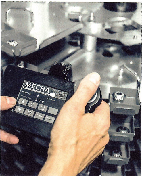
3 Das bewegliche Bedienpanel bietet eine einfache, übersichtliche Bedienung mit Touch-Bildschirm (© Mecha)
